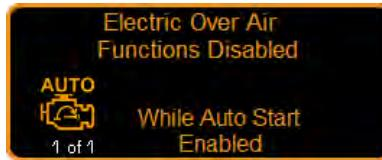
Se mostrará el mensaje "XXXX" si se opera algún interruptor de accesorio neumático mientras el sistema de arranque automático está activado.
