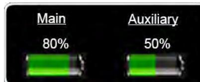
El sistema de arranque automático mostrará el Estado de carga (SOC) de las baterías de arranque y auxiliar mientras las baterías se cargan. Las baterías auxiliares están en el paquete de baterías separado incluido con un sistema de aire acondicionado eléctrico instalado en la fábrica. Si el SOC no está disponible, el valor del porcentaje numérico se reemplazará con "- -".
