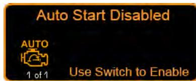
Le message Use switch to enable (actionner l'interrupteur aux fins de mise en fonction) indique que le système de démarrage Auto-Start a fait l'objet d'une annulation par l'utilisateur et qu'il est prêt à se mettre en fonction sur pression de l'interrupteur.
