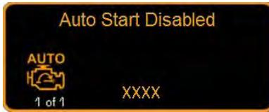
Este mensaje se mostrará cuando no se cumpla con los interbloqueos de seguridad después de activar el sistema. Asegúrese de que se cumpla con todos los interbloqueos. "XXXX" indicará el interbloqueo específico sin cumplimiento.
