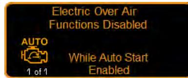
Le message « XXXX » s'affiche si l'interrupteur de commande d'un accessoire pneumatique quelconque est actionné, alors que le système de démarrage Auto-Start est mis en fonction.
