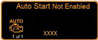
Este mensaje se mostrará cuando se intenta activar el sistema de arranque automático cuando no se cumple con los interbloqueos de seguridad. Asegúrese de que se cumpla con todos los interbloqueos. "XXXX" indicará el interbloqueo específico sin cumplimiento.
